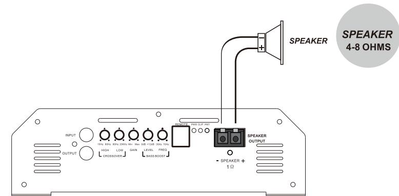
**Fig 3 FRONT PANEL CONNECTOR**
